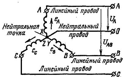
Рис. 7-5. Схема соединения обмоток генератора звездой.
