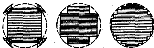
Рис. 9-4. Сечения сердечников трансформаторов.
